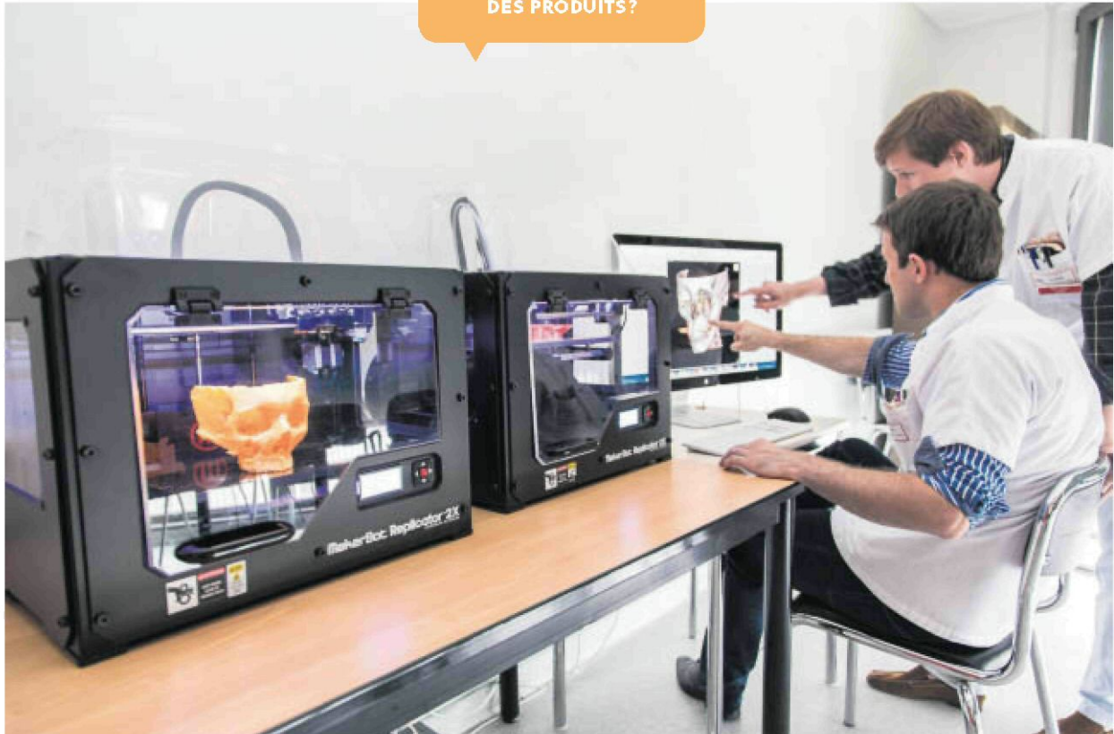
DANS UN SERVICE DE CHIRURGIE DU CHU DE DIJON. IMPRESSION TRIDIMENSIONNELLE DU SQUELETTE FACIAL D'UN PATIENT. PHOTO GARO/PHANIE
